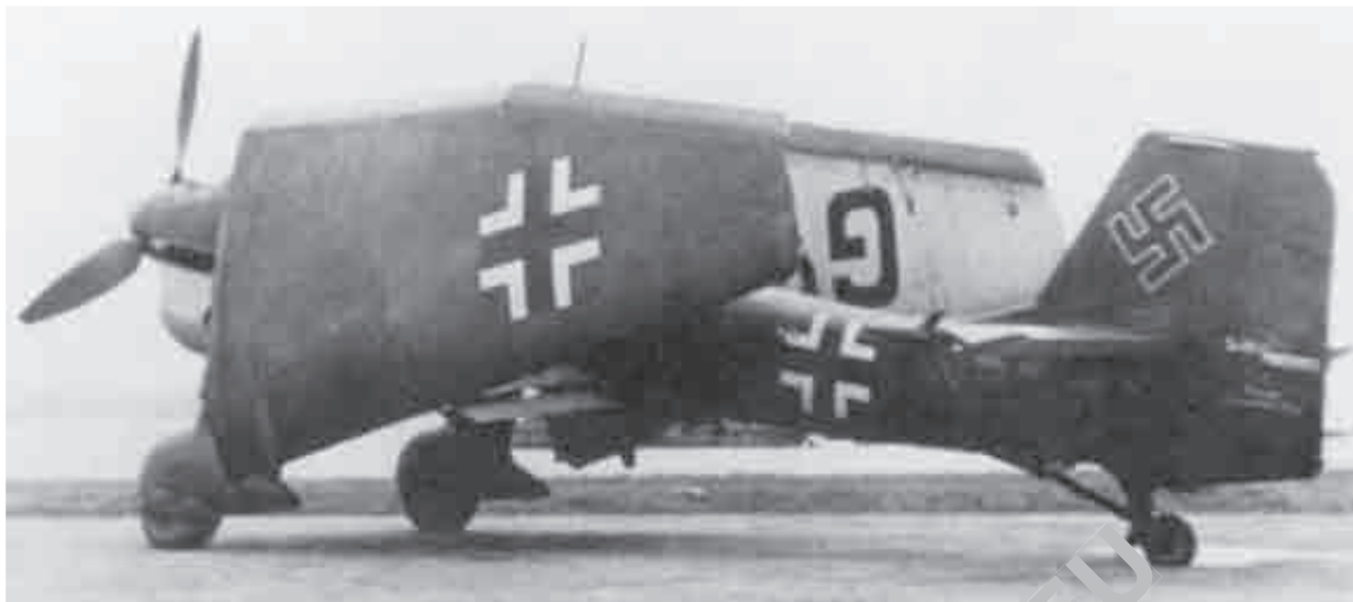
Junkers Ju 87C-1, WNr. 0569, GD+FB, oblatany w kwietniu 1941 roku. Przy kółku ogonowym widoczny hak do lądowania. Junkers Ju 87C-1, WNr. 0569, GD+FB, test flown in April 1941. Arrestor hook is clearly visible by the tailwheel. (Via Marian Krzyżan)
