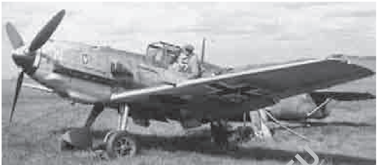
Ten Messerschmitt Bf 109 T służył w 1943 roku do szkolenia pilotów nocnych myśliwców w NJG 101 stacjonującym na lotnisku Manchung. Biała litera N na osłonie silnika oznacza silnik DB 601 N.
