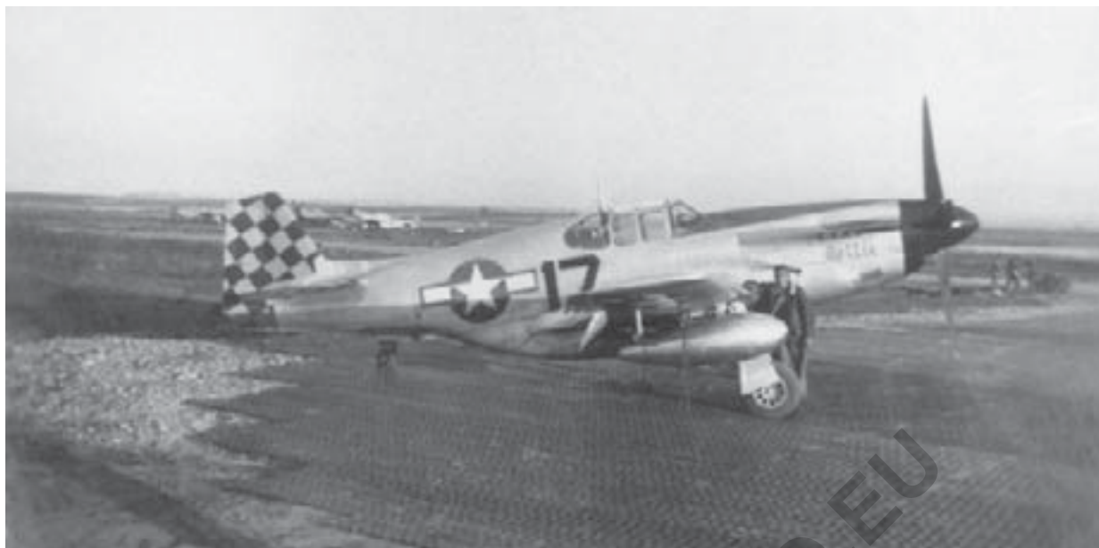
P-51B lub C (n/s nieznany), o kodzie bocznym „17” i imieniu Dottie , z 317. FS (325. FG). Lesina, Włochy, lato 1944 roku. Pod skrzydłami widoczne odrzucane zbiorniki na 75 galonów paliwa.
